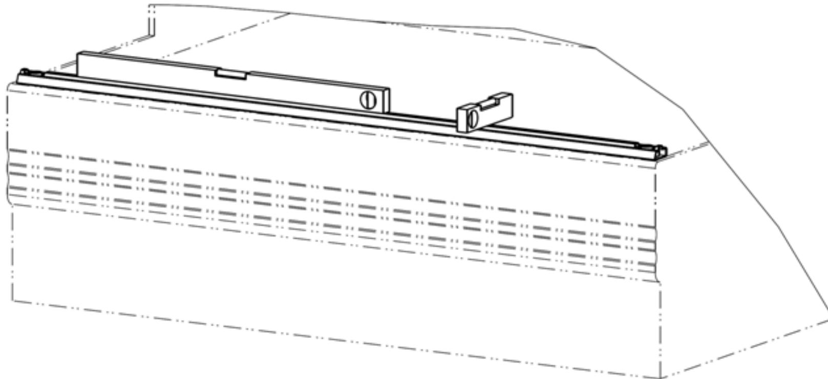
D) Rahmenprofil einsetzen und ausrichten / Insert frame profile and align
