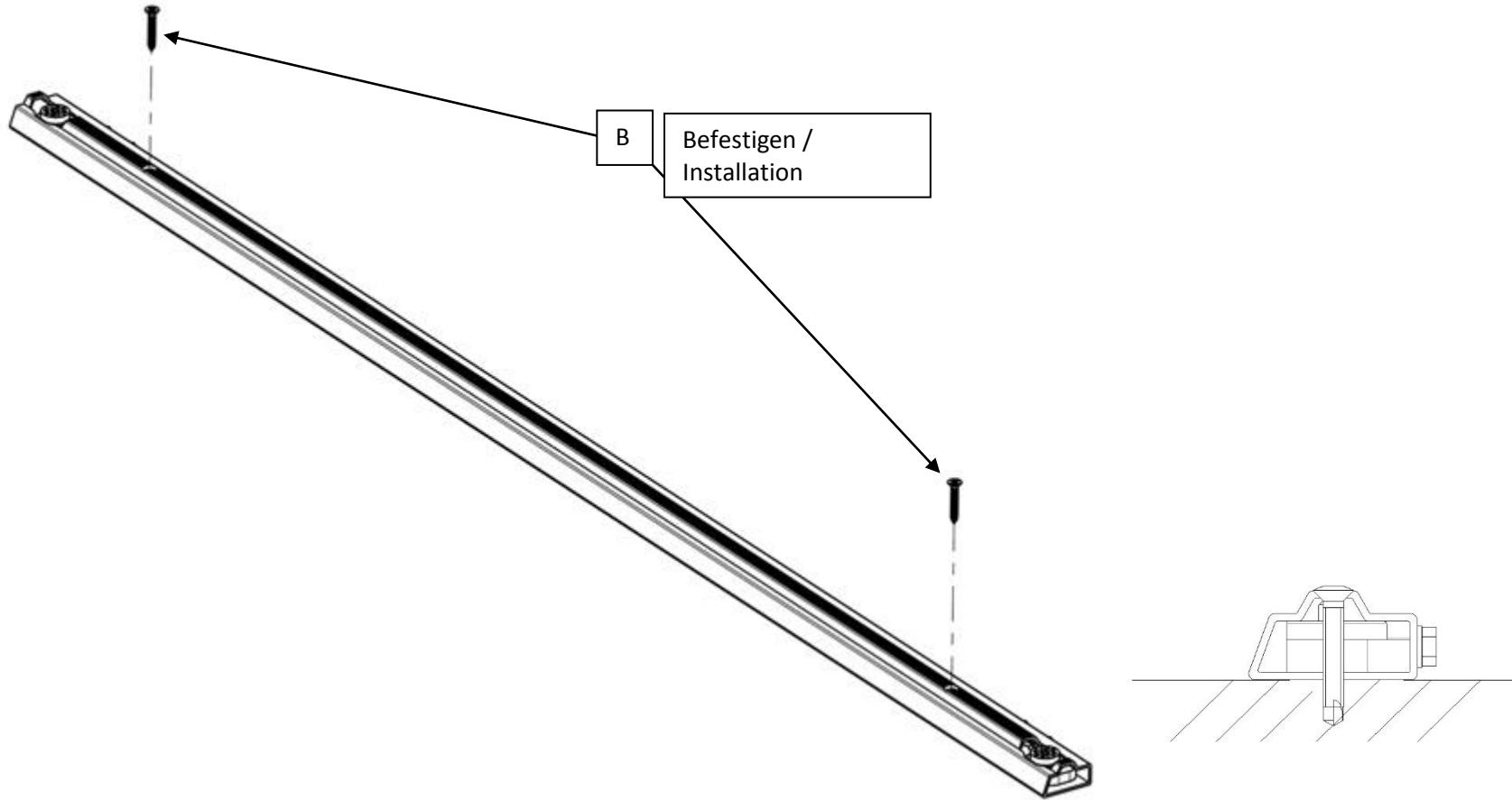
E) Rahmenprofil befestigen / Attach lower frame profile
