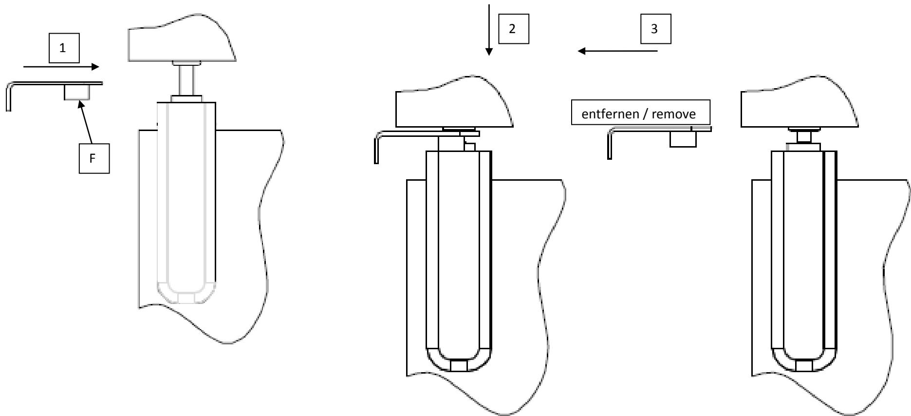
H) Tür schließen, Montagehilfen aufstecken, dann obere Anpassung absenken und befestigen /
